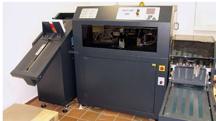
Der neue Dreiseitenschneider FKS/Challenge CMT-130 bei Digi Print in Münster kann einzelne oder mehrere klebegebundene Produkte gleichzeitig und vollautomatisch in einem einzigen Arbeitsgang dreiseitig beschneiden.
